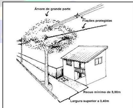
No caso de árvores com porte inadequado para plantio sob fiação, já plantadas, cujas copas estão em contato com a rede aérea, uma opção é implantar soluções de engenharia como, redes isoladas, protegidas, multiplexadas ou compactas, que permitam melhor convivência com a arborização existente.
